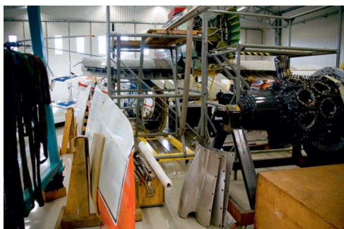
Staffan och Dan studerar rörliga foder och insugningskanaler, avgasöppningar till Sea Fyrins Bristolmotor. Dan ska tillverka ett flertal foder och det finns en efterfrågan från andra Sea Fury-ägare. Nedan massor av delar, bl a Shoestrings vinge i ett hörn.
