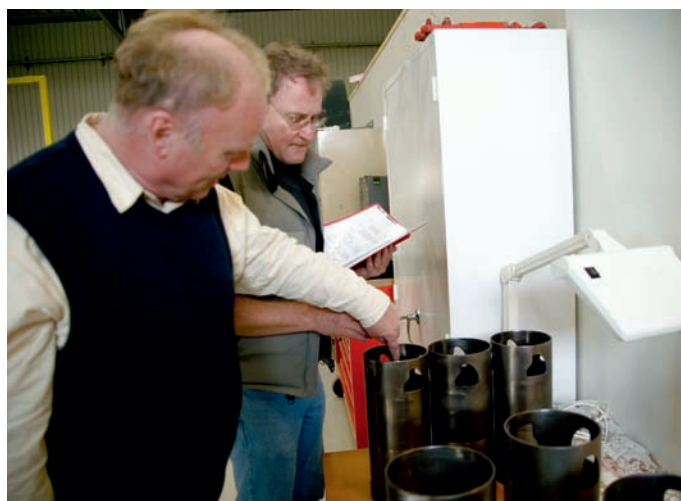
Staffan och Dan studerar rörliga foder och insugningskanaler, avgasöppningar till Sea Fyrins Bristolmotor. Dan ska tillverka ett flertal foder och det finns en efterfrågan från andra Sea Fury-ägare. Nedan massor av delar, bl a Shoestrings vinge i ett hörn.
