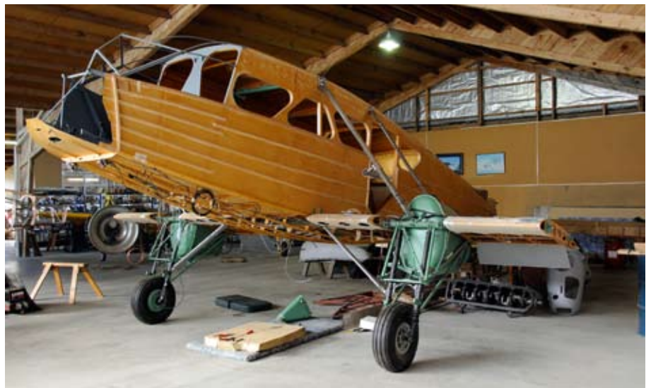
DH.89B Dominie (Rapide). Man köpte ett vrak, plockade bort alla metallbeslag och startade så byggandet av en helt ny träkropp där man återanvände metallbeslagen. Ett mastodontprojekt! Rapide är den civila beteckningen medan den kallades Dominie i engelska och nyzeeländska flygvapnen. Foto: Kenneth Sandberg.
