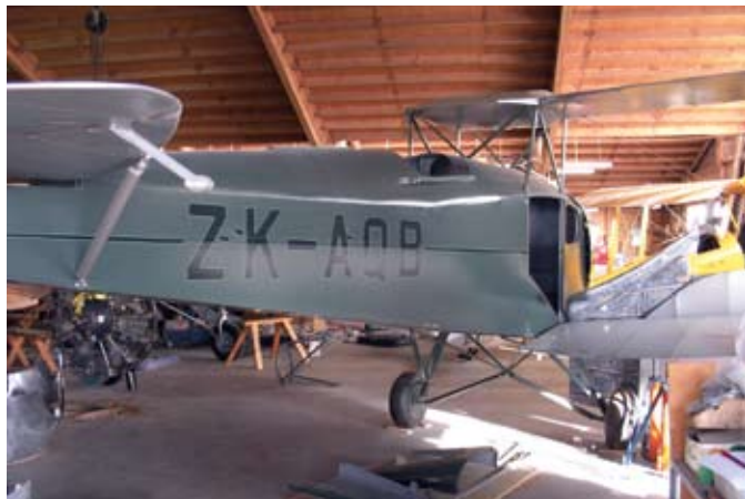
DH.83 Fox Moth. Ett mycket märkligt flygplan, piloten satt i egen sittbrunn och med passagerarna (3 st) i en kabin framför. Ett otroligt fint duknings- och målningsjobb som det var en fröjd att se på. Flygplanet lämnat för restaurering för länge sedan. Pengarna tryter tydligen hos beställaren varför den har blivit stående en längre tid i nästan färdigt skick. Foto: Nicklas Amrén.
