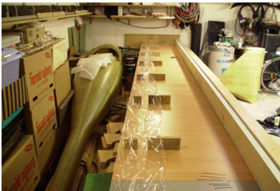
Vingbalk innan lamminering. Nedan t v: prov placerat vingen i jiggen (en kompis på bilden). Nedan Jiggens uppbyggnad.
