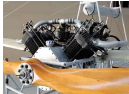
Replika av flygplan byggt av H. J. Pither ursprungligen tillverkad 1910. V-motor 40 hp. Inget bevis finns dock för att originalflygplanet verkligen flög 1910. Kopian har gjort några hopp vilket visar att den kan flyga. Foto: Kenneth Sandberg.
