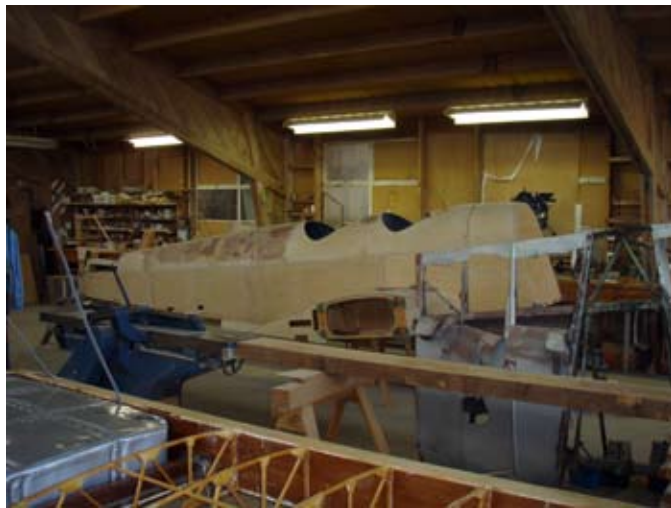
DH.94 Moth Minor. Ett lågvingat monoplan med mycket små sittbrunnar! Kroppen träfärdig. Foto: Curt Sandberg.
