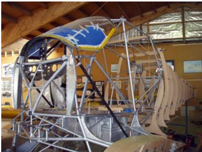
Beech C17B Staggerwing från Queensland, Australien. Flygplanets duk och trä började bli i dåligt skick och flygplanet sändes i container till Mandevill. Allt trämaterial har nu bytts ut. Återstår några tusen arbetstimmar! Foto: Curt Sandberg.
