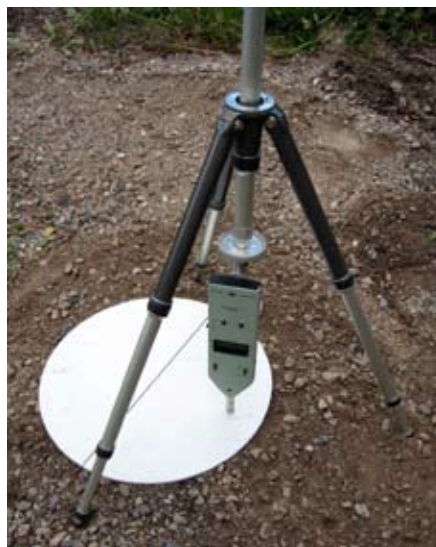
Ljudmätaren, som är monterad över en aluminiumplatta, registrerar ljudet under hela överflygning. När flygplanet är rakt över mätaren registreras mätvärdet.
