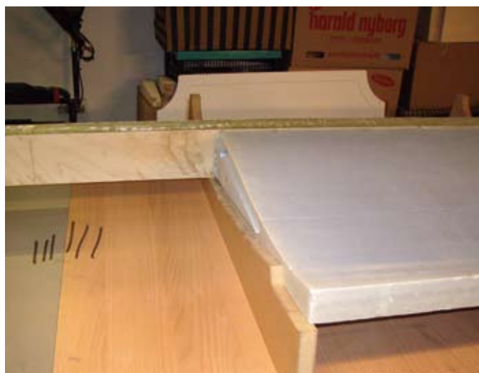
Vingbalk innan lamminering. Nedan t v: prov placerat vingen i jiggen (en kompis på bilden). Nedan Jiggens uppbyggnad.
