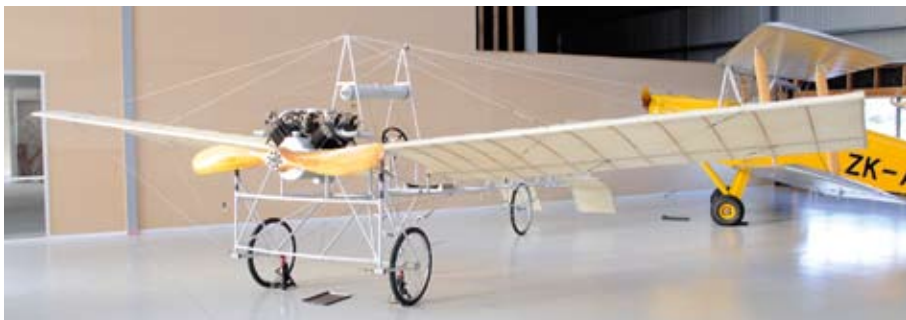
Replika av flygplan byggt av H. J. Pither ursprungligen tillverkad 1910. V-motor 40 hp. Inget bevis finns dock för att originalflygplanet verkligen flög 1910. Kopian har gjort några hopp vilket visar att den kan flyga. Foto: Kenneth Sandberg.
