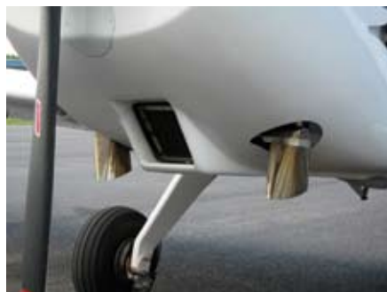
Dubbla Liese-dämpare monterade under Zenair SE-XYZ. Gav godkända värden.
