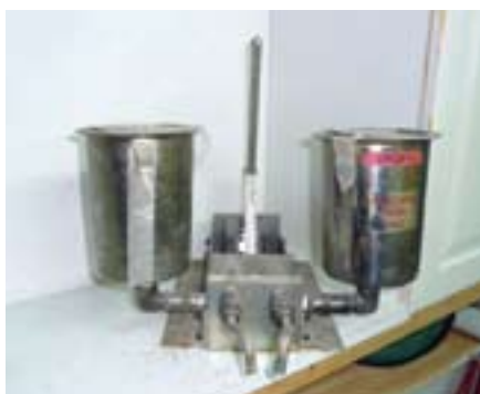
Balansvåg (överst) eller epoxipump för att väga upp epoxi och härdare, bägge klarar jobbet lika bra.
