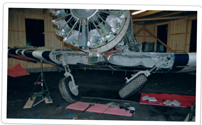
Först gången stället går in. Landningsställ och klaff är hydrauliska och drivs av en pump på motorn.
