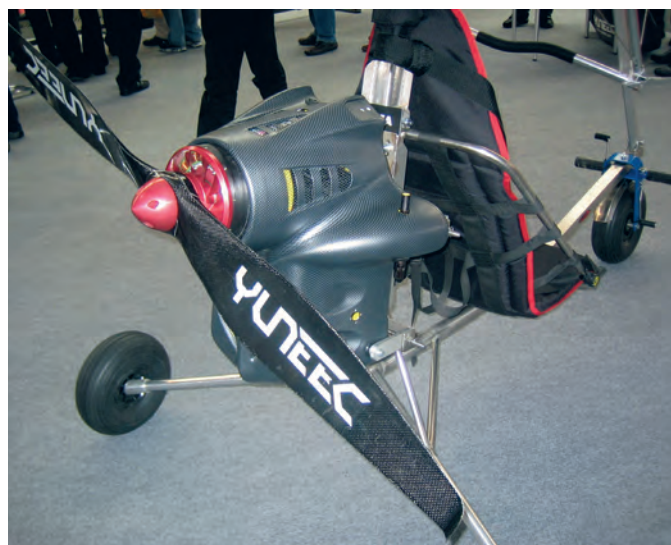
En komplett "paramotor" med elmotor, batteri och fartreglage på 28 kg från Yuneec.
