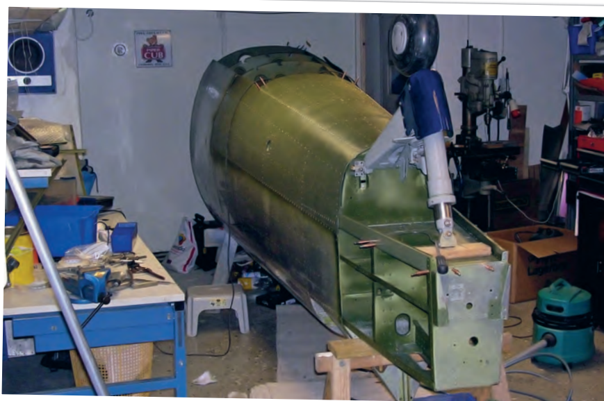
Skalplåtarna utbytta och luckorna och signallamporna är borta. Det modifierade sporrhjulet är provmonterat.
