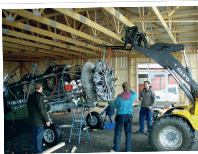
Motorn monterades med hjälp av traktor i den under uppförande nya hangaren.
