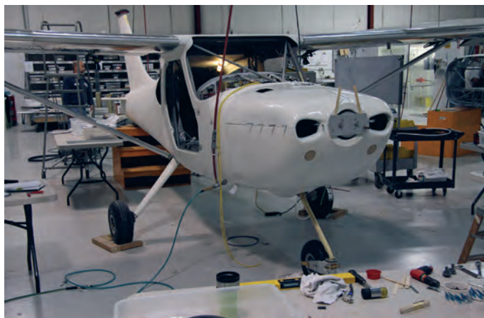
Övre och undre motorkåporna har finjusterats och provmonterats.
