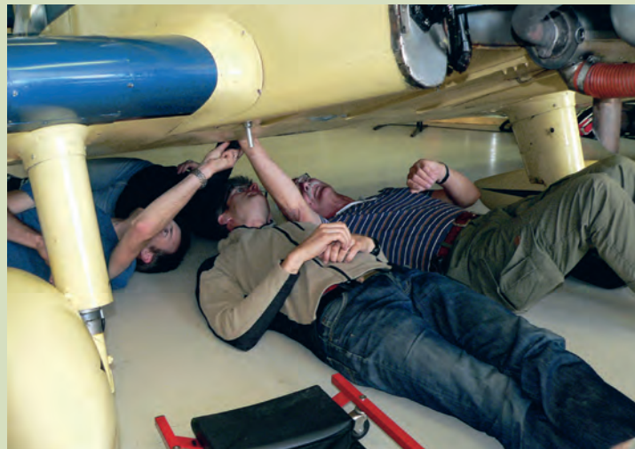
Kontroll av linspänning, trångt under kärran!
