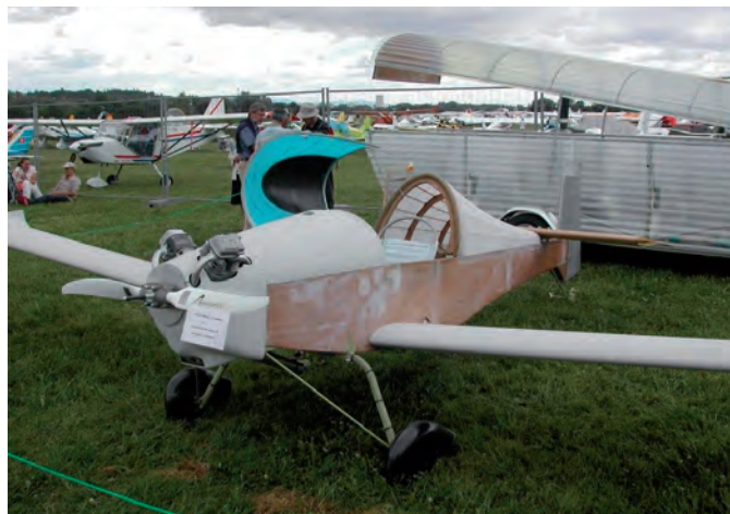
Ekonomiflygplanet i den lätta ensitsiga klassen var Avion Colomban MC 30 Luciole. Tomvikt 97 kg och max vikt 200 kg. Med motor Vanguard, 2-cylindrig, 4-takt, 25 Hp, 627 cc, 23 kg. Prestanda 170 kt, 63 stall och 6,1 l/h.
