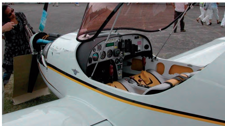
Designe Senge Pennec, tvåsitsig med 1,4 l, 53 hp dieselmotor. Totalt 67 l diesel ger cirka 10 timmar. Så här ser framtidens flygplan ut.
