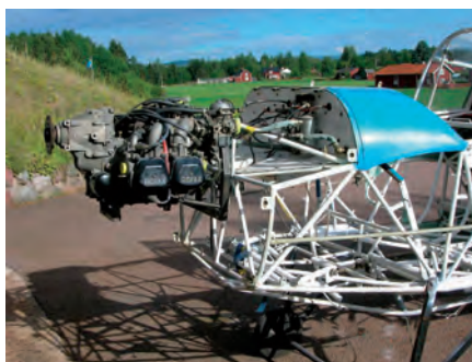
En begagnad Rotax 912 med bra gångtid kvar inköptes. Här är den på plats.
