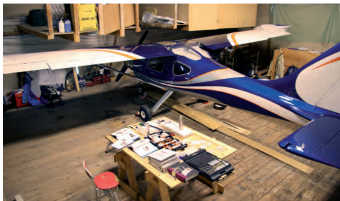
Båda vingarna samt roder och klaff monterade och riggade.
