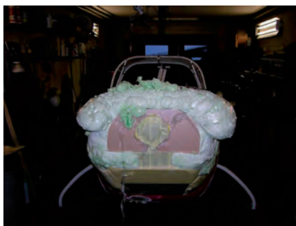
Motorfundamentet fixades och en ombyggnad av motorkåporna gjordes. Det här ska bli motorkåpor.
