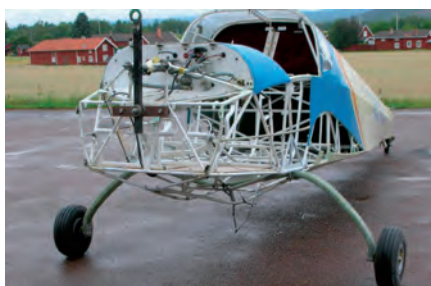
Kroppen riktades och förstärktes för att passa det nya landningsstället.
