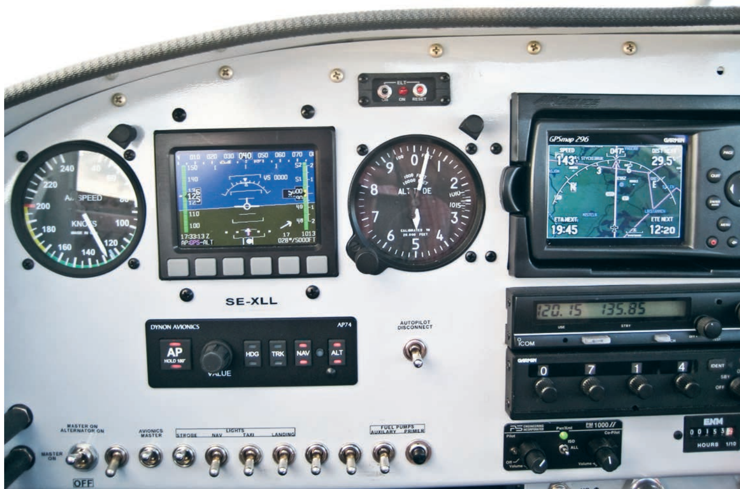
5000 fot över Södermanland under en flygning från Linköping till Skå-Edeby. NAV är aktiverat så AP:n följer ruten på GPS:en. ALT är aktiverat och buggen satt på 5000 ft. QNH var 1013 den här dagen. HDG-buggen står på 028 grader men den används inte nu. Sidvindskomponenten är 17 knop och som synes håller AP upp mot vinden.
