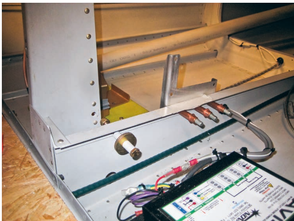
Montering av fästet för höjdroserservot pågår. Tre nitar fick borras ur och tre nya hål borrades i nedre kan delvis skyddad av trimkabel. Sen nitades det med Cherrymax-nitar.
