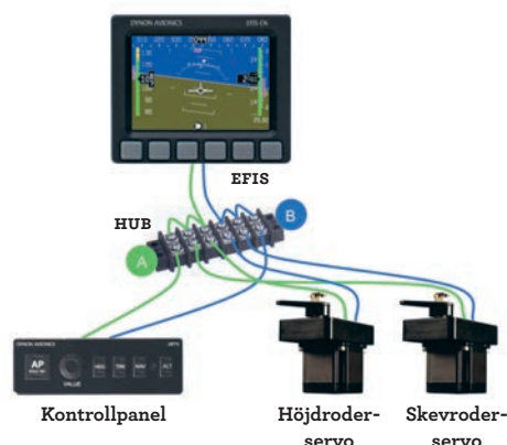
DSAB bussen i stjärnform. Hubben består av en kopplingsplint.
