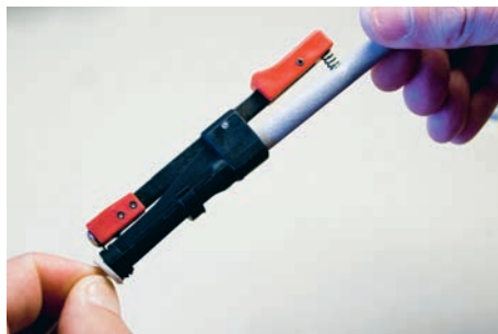
2. Skalning av kabel.
