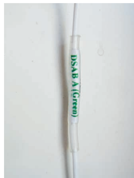
10. Kabel märkt med etikett under transparent krympslang.
