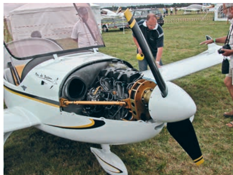
En Gaz'aille 2 med PSA 1,4 liters bil-dieselmotor. 53 hp vid 5000 rpm, reduktionsväxel på 1.875, 7 l/h och 200 km/h, aktionstid 9 timmar, Tom-/max-vikt är 280/470 kg.
