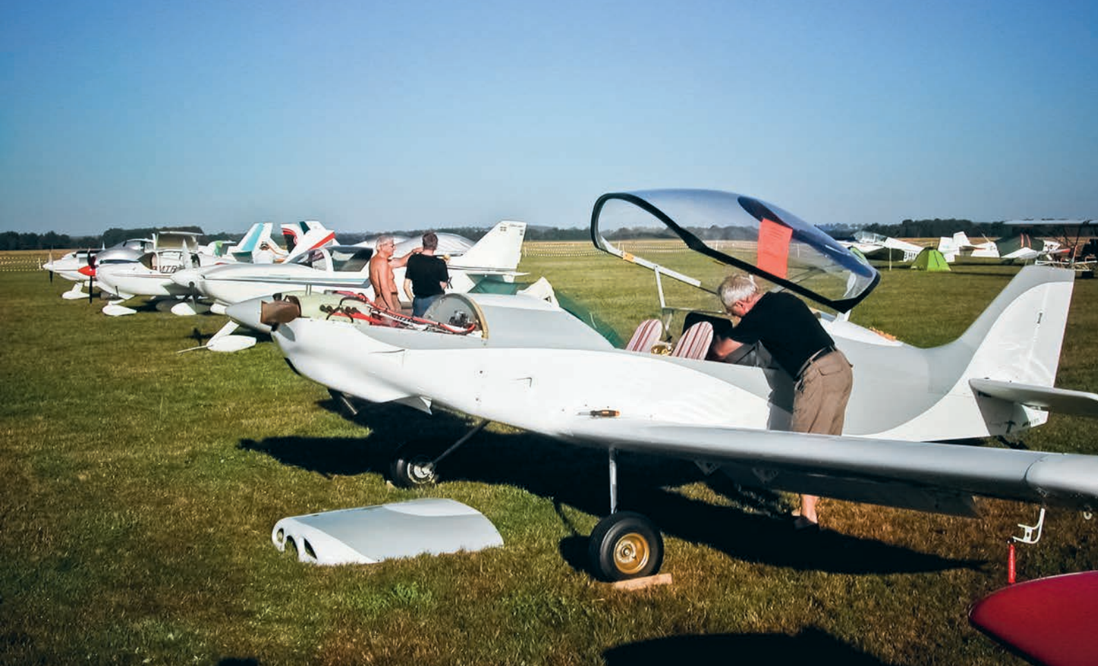
En nykonstruktion, JPM 03, flygplansindivid nr 11. JPM står för konstruktören Jean Pierre Marie. Jabirumotorn på 85 hp är den flygmotor med lägsta vikten, tomvikten är 260 kg, maxvikt 450kg, vilket ger en lastförmåga på 190 kg. Stallfart 60 km/h, maxfart 250 km/h. Bensinförbrukning 15 l/h och då flyger den med 95–100 kt. Trenden är tydlig i Frankrike med lätta snygga tvåsitsiga flygplan med låg bensinförbrukning (15–18 l/h).
