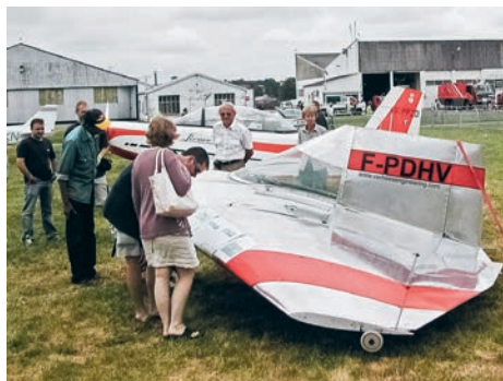
Verhees Delta konstruerad och byggd av Bart Verhees. Det har en Subaru-motor på 50 hp och flyger i 120 kt. Det finns i ett exemplar.
