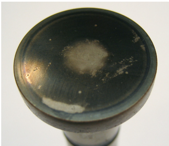
Ventillyftare. Då kamnocken korroderat och kontaktytan därmed förändrats har lyftaren slutat rotera. Se de blanka ytorna på tallrikskanten. Rostsporerna är igenom den härdade ytan. Nu har slitageförloppet accelererat utan kontroll.
