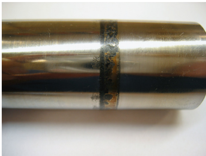
Denna kolvbult (ovan till vänster) kommer från en Lyc. O 320. Kamaxel (ovan till höger) ur samma motor. Korrosionen syns tydligt och är på sina ställen ca en millimeter djup. Har du den tunnväggiga kolvbulten är denna korrosion mycket kritisk.
