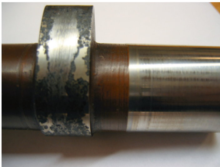
Denna kolvbult (ovan till vänster) kommer från en Lyc. O 320. Kamaxel (ovan till höger) ur samma motor. Korrosionen syns tydligt och är på sina ställen ca en millimeter djup. Har du den tunnväggiga kolvbulten är denna korrosion mycket kritisk.
