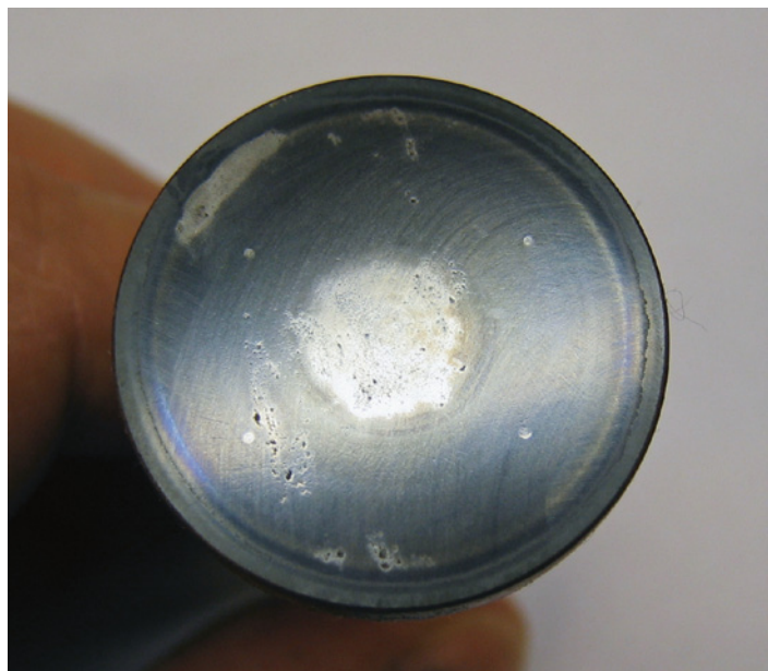
Ventillyftare. Då kamnocken korroderat och kontaktytan därmed förändrats har lyftaren slutat rotera. Se de blanka ytorna på tallrikskanten. Rostsporerna är igenom den härdade ytan. Nu har slitageförloppet accelererat utan kontroll.
