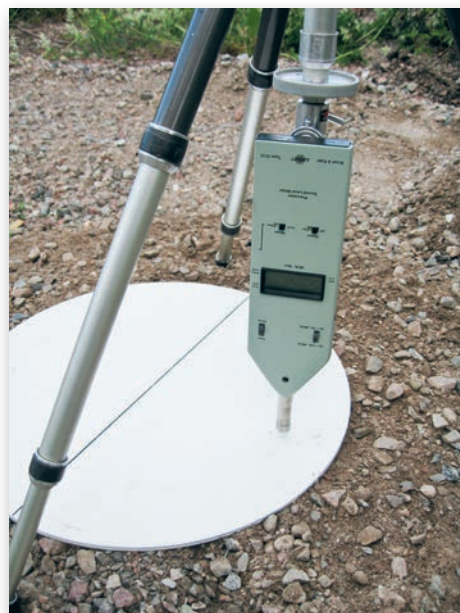
Ljudmätaren placerad med mikrofonen sju millimeter över aluminiumplattan som ligger på marken.
