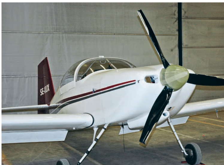
Endast mindre justeringar har varit nödvändiga för att anpassa cowlingen till den nya motorn. En elektrisk ställbar IVO Propp har monterats.
