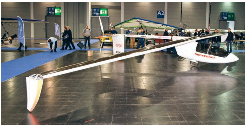
Sunseeker II byggdes av Eric Raymond 2002. 2009 blev det det första soldrivna flygplanet att flyga över Alperna. Det har lite litium-jon batterier för start och första stigning. Därefter klarar den sig på solenergi. Se www.solar-flight.com . TEXT & FOTO: KJELL-OVE GISSELSO
