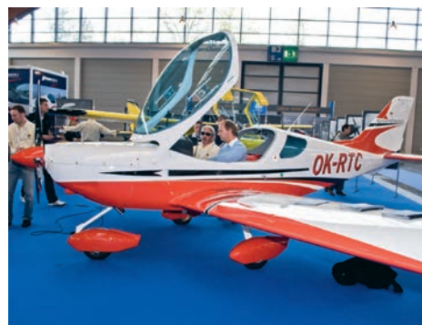
Sport Cruiser tillverkas av Czech Sport Aircraft. Den såldes ett tag av Piper under namnet PiperSport, men det samarbetet har nu upphört. I år har ett antal små modifieringar införts, t.ex. ändrade roderytter, hjulkåpor, vingspetsar. BRS (räddningsskärm) kan numera väljas bort. Se www.sportaircraftworks.com . TEXT & FOTO: KJELL-OVE GISSELSOHN
