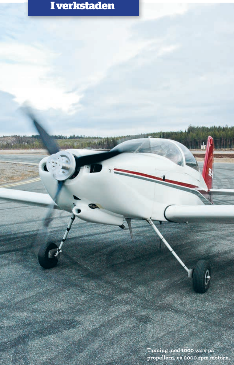
Endast mindre justeringar har varit nödvändiga för att anpassa cowlingen till den nya motorn. En elektrisk ställbar IVO Propp har monterats.
