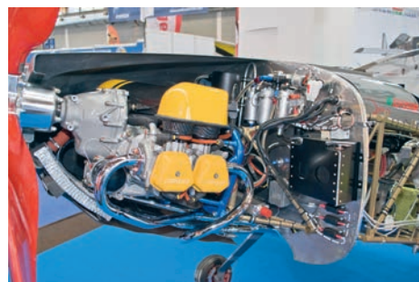
Rotax motor försedd med elektronisk insprutning och tändning från EPA Power. Se www.epapower.com .
