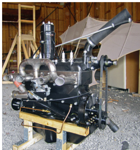
Motorn som skall driva Air Campern är klar och vänta på montering. Det är en Ford Model A sidventils-motor.
