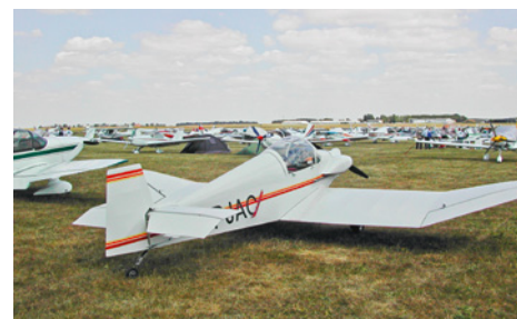
En ensitsig Jodel D92 med VW motor med en Scintilla-magnet som orsakar den höga knölen på cowlingen.
