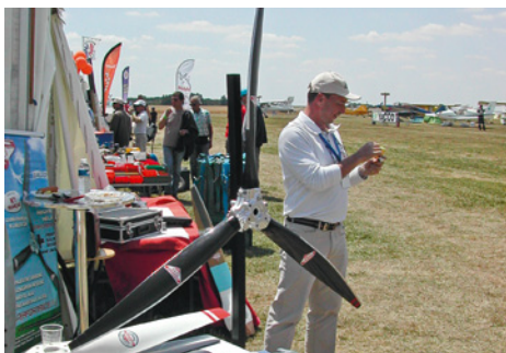
ERVA med sin nya kolfiberpropeller med ett snyggt nav. Framkantskoningen är i aluminium och håller för flygning i regn.
