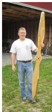
Per har själv tillverkat propellern. För att klara detta hade han en master som förebild i en propeller-kopierare. Serienumret är PW001.
