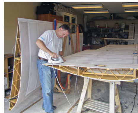
Här läggs sista handen på dukningen av vingarna. Nu återstår lackering.
