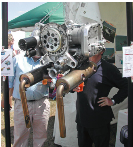
D-motor. 80 HP, 4 cylindrar, 4-taktare, 2 tändstift per cylinder, alternator på 20 amp och startmotor, Den går på 95 oktän. Tomvikt 52 kg med avgassystem, kylare och oljetank.
