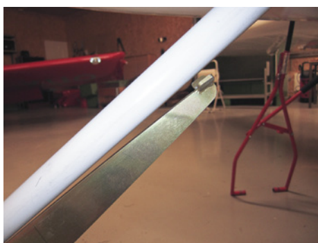
Spelet i dämparens överkant är bara fyllt när belastningen på benet blir för hög.
