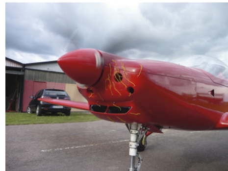
Luften sugas ut i stället för att pressas in i det högra övre luftintaget vid spinnern
