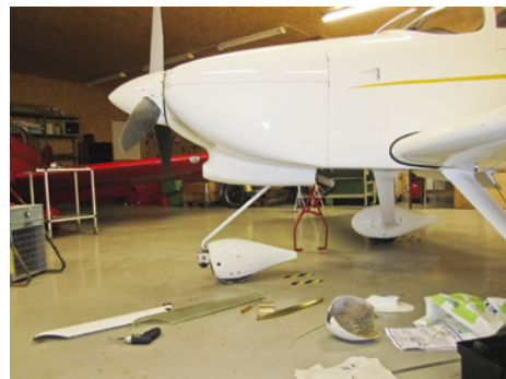
Noskåpan och kåpan över benet är bortmonterade.
