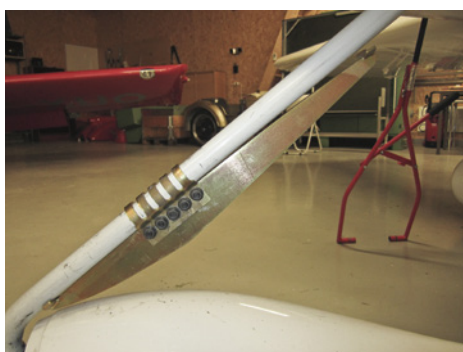
Dämparen monterad. Fem bultar var allt som behövdes.
