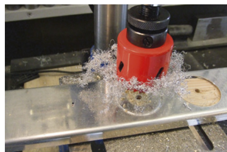
16 juni: Det blir en del lätthål att borra, här i balk till skevroder.
