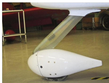
Här är den nya kåpan över benet inpassad och provmonterad. Nu återstår bara lackering.
