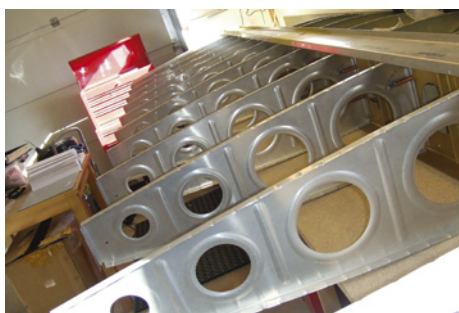
20 april: Spryglar på plats på vingbalk, nu börjar det likna något.
