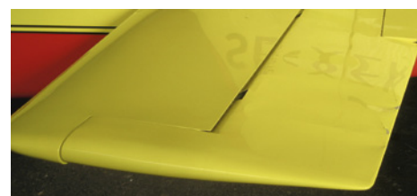
Svårt att se på bilden men höjdrodret var skrynkligt. Det sitter tunga balansvikter i spetsen på höjdrodret som troligen överbelastat strukturen vid nedslaget.
