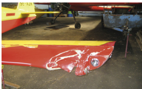
Skadorna på vingspetsen. Detta tryckte även in bakre vingbalks infästning i kroppen så att den genomgående balken kröktes.
