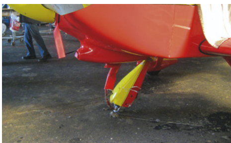
När nosstället vek sig in under kroppen bromsades planet kraftigt så att det ställde sig på spinnern för att sedan slå runt på ryggen.
