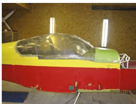
Huven kommer som en stor bubbla som sedan måste trimmas i kanterna för att passas in för att sedan delas i en främre och en bakre del.
