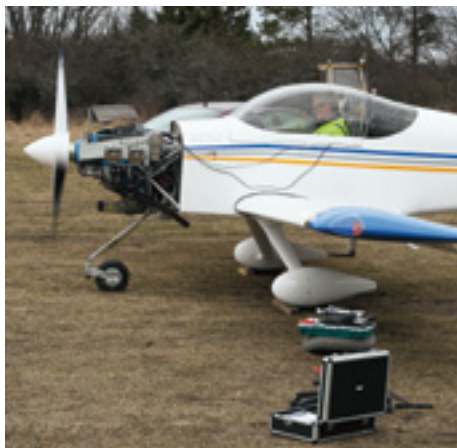
Körning, kablarna säkrade och balanseraren i cockpit. Full gas, tryck på Average och vänta några sekunder.
