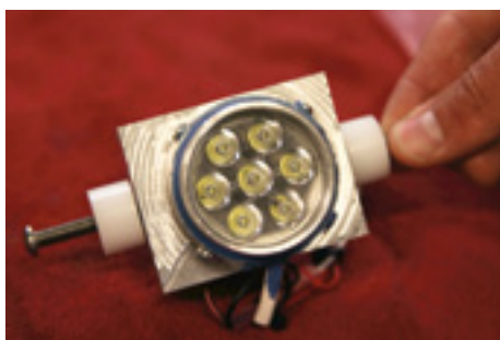
Landningsstrålkastarens framsida, sju dioder med linser över.
