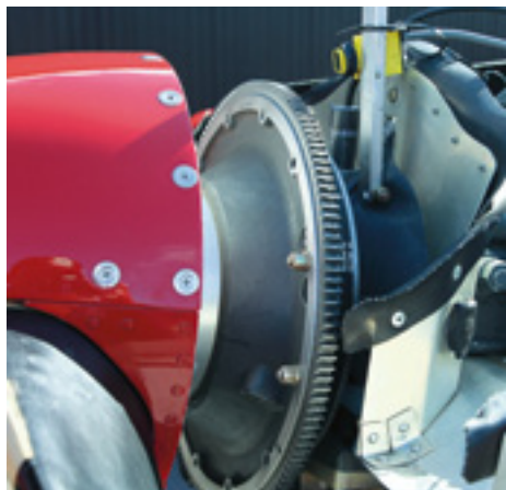
Vikterna utgörs i detta fall av AN4 bult, mutter och bricka.
