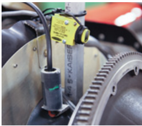
Sensor och optisk pickup, fästena tillverkades av aluminiumprofiler.
