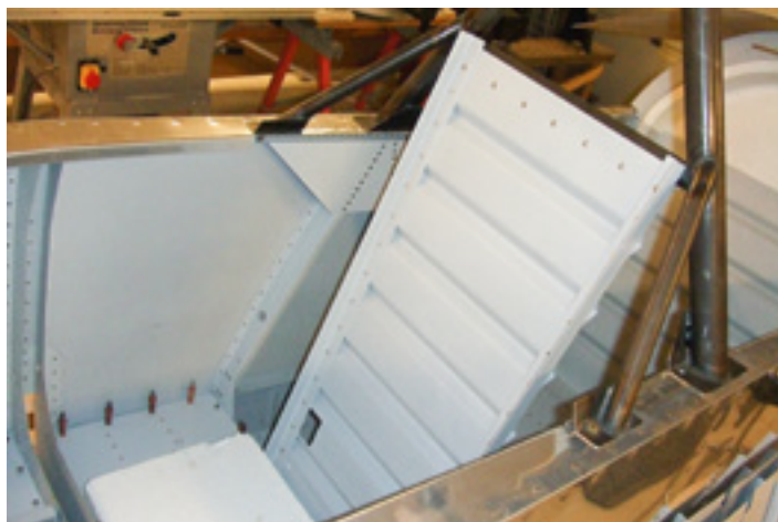
Tvättbräda? Nej, ryggstöd för piloten.
