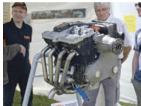
Detta verkar vara en MC-motor som konverterats till flygbruk. Den heter Vija och finns i 2 varianter på 100 resp. 120 hk. Båda väger 84 kg. De kostar 9 500 resp. 13 000 Euro. Se www.vija-engines.com .
