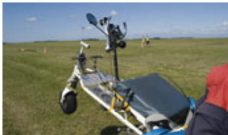
»Cockpit« på Breezy RLU-1. Under plexiglasen framför sitsen sitter diverse instrument. Fartmätaren framför pedalerna har ett venturirör monterat på sig. Bakspeglarna är till för att kunna se varvräknaren som sitter under vingroten. Givetvis finns även en tuta!
