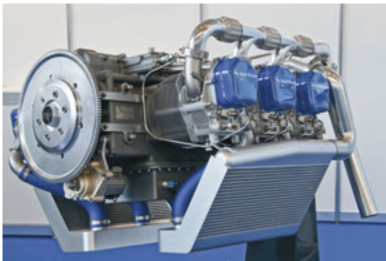
En ny 6-cylidrig motor från franska SMA. Effekten angavs till 330 hp.
