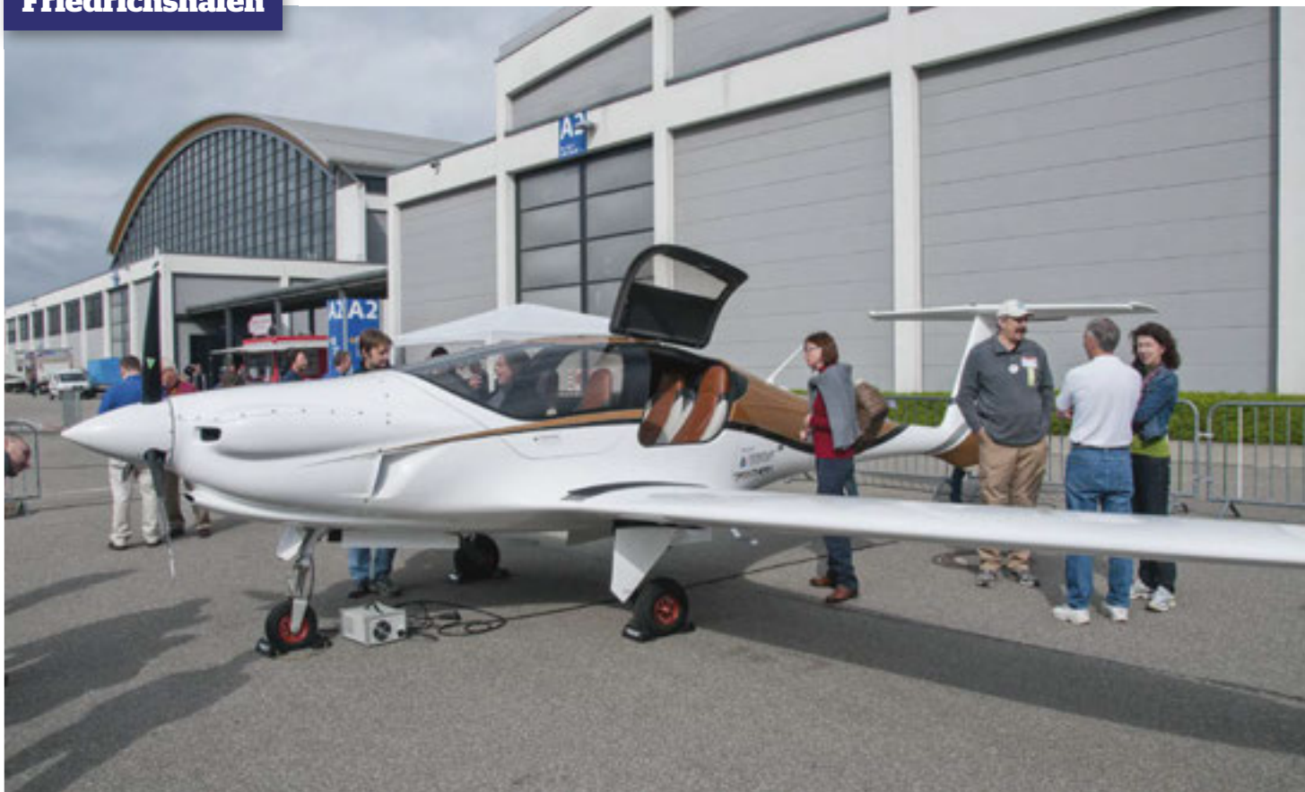
Pipistrel Panthera som var sprillans ny, den här prototypen flög för bara några veckor sedan och har nu 25 flygtimmar. Flygplanet är 4-sitsigt. Motorer på ca 200 hp används. Marschfart anges till 200 kt. Ett ex är sålt till Sverige.
