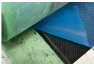
Priprep på rulle med två olika plastfolier, vilka man avlägsnar vid lamineringen.
