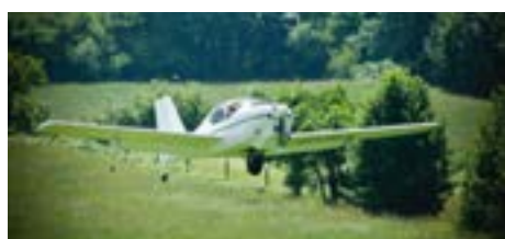
Tidigare landställskonfigurationen, med ett centralt placerat hjul under kroppen.
