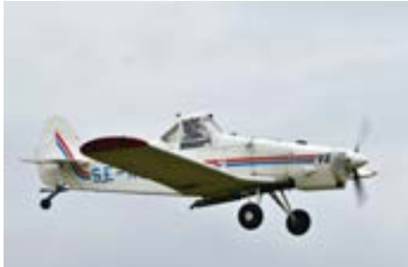
Sundsvalls Segelflygklubbs Piper Pawnee, SE-KSL, med Chevrolet V8-motor installerad. Pilot Lage Norberg. FOTO: STAFFAN NORBERG
