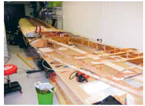
Förlängt garage med vingen på den 8 meter långa arbetsbänken. Vänster vinge behövde byggas upp på nytt, vilket framgår på bilden.
