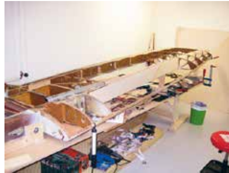
Vingbalken klar och spryglarna passas in.
