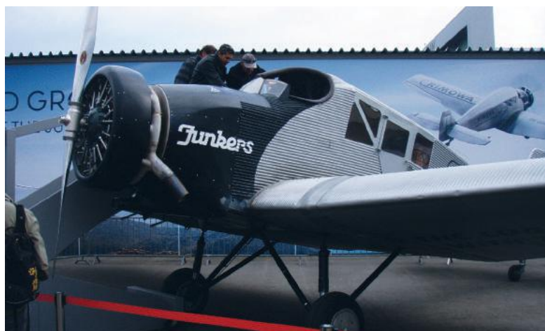
En i Schweiz nyttillverkad Junkers F13 dock med en Pratt & Whitney-motor. Öppen cockpit!
