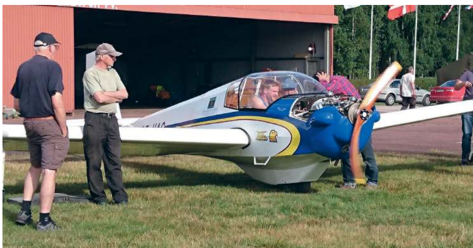
170807 Efter flera års stillestånd kunde Siljansnäs FK äntligen motorstarta sin nybyggda Great Planes (VW)-motor i sin EAA Falke. Ove Hermans, Orsa, motorbyggare, Toffe kontrollant. Premiärflygning väntas ske inom kort. Foto Ingrid Muus.
