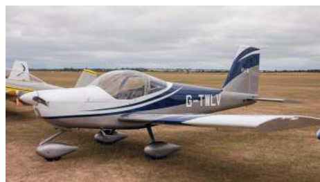
RV-12, 2-sitsig side-by-side, amerikansk LSA. Motor är Rotax 912iS eller 912ULS på 100 hp.
