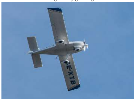
RV-9A, 2-sitsig side-by-side, ej aerobatic, annan vingprofil än tidigare modeller, rak stabilisator. Kan ta motorer från 118-160 hp.
