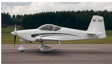
RV-7A, 2-sitsig side-by-side, ersatte RV-6, mer förbearbetad byggstats och omkonstruerad vinge, och kan ta upp till 200 hp motor. På bilden med tip-up canopy.
