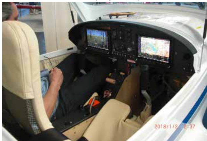
SDplanes SD-2, en trä/komposit-kärra med Rotax. Vingprofilen är GA 37U-A315. Deras SD-1 såg ni på vårt flyin 2016.
