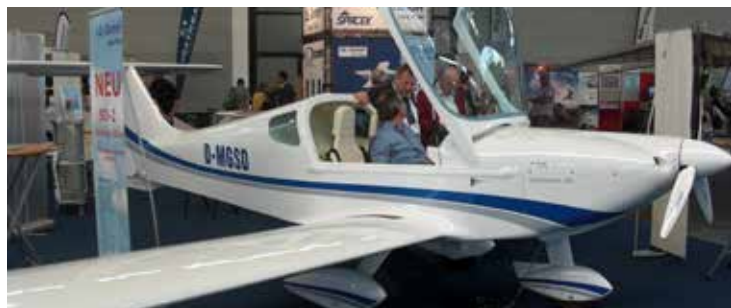
SDplanes SD-2, en trä/komposit-kärra med Rotax. Vingprofilen är GA 37U-A315. Deras SD-1 såg ni på vårt flyin 2016.
