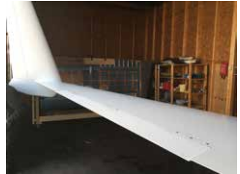
RV-14 plåtvingarna i bakgrunden, Cozy glasfibervinge i förgrunden.
