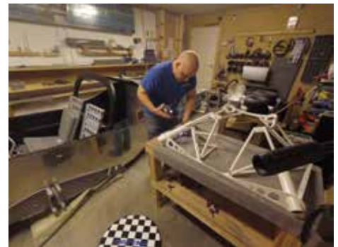
Motorfundamentet på bänken
