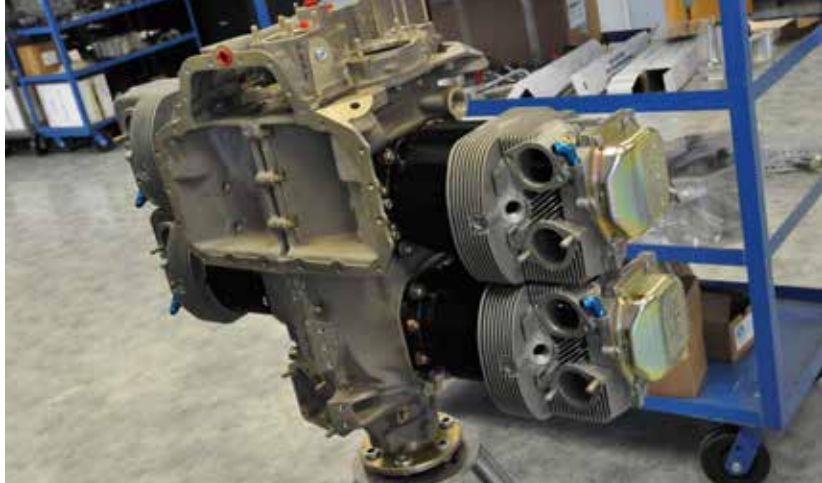
Cylindrar monterade, med stötstänger, lyftare m.m.
