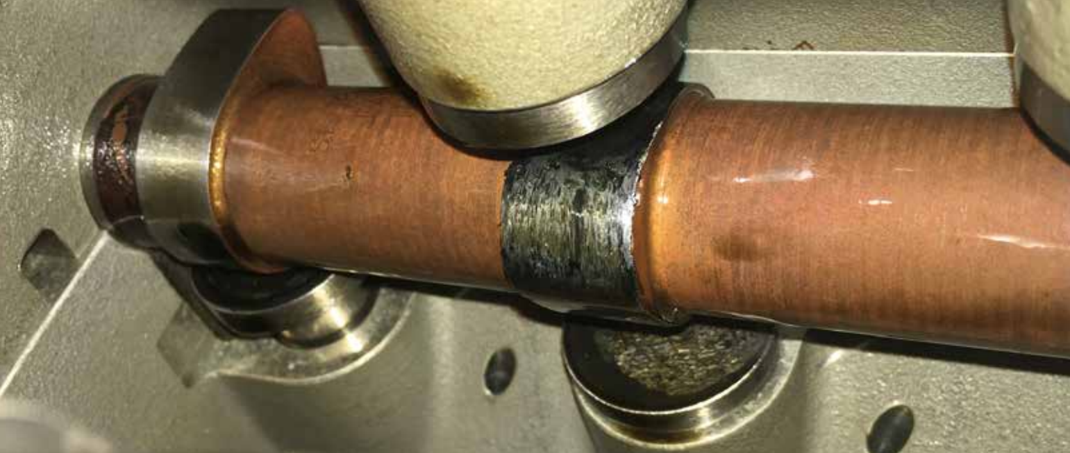
Nedsliten kamnock och gropig lyftare
