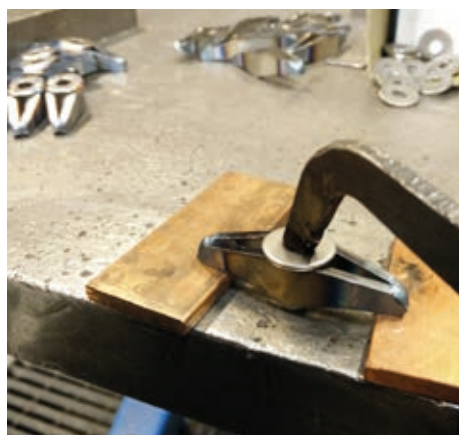
Svetsa överfall för bakre vingbalk
