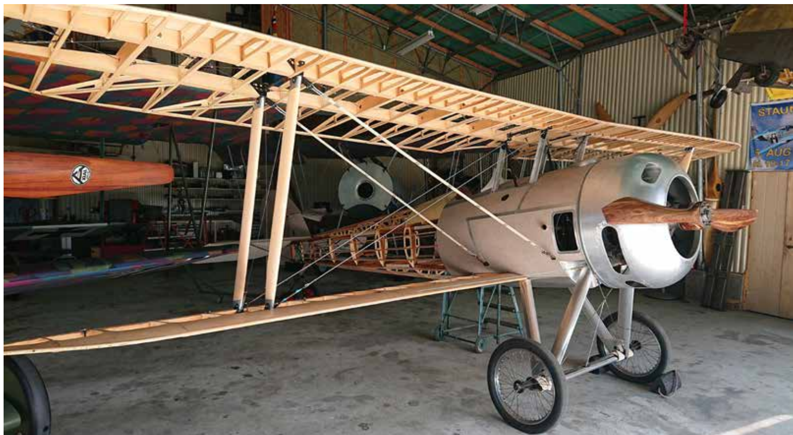
Provrigging. Foto: Mattias Jönsson
