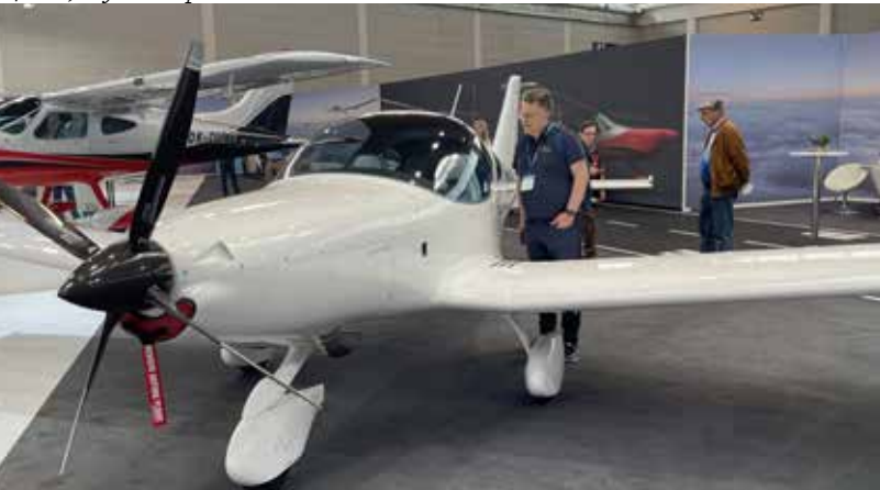
Bristell Turboprop. MTOW 600kg, 130 hp, 25 l/h, Jet A1/Diesel, TBO 3000 h.
