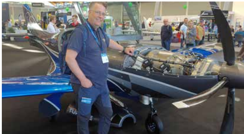
Här ett flygplan med den franska turbinmotorn från Turbotech på 140hk, mycket spännande!
