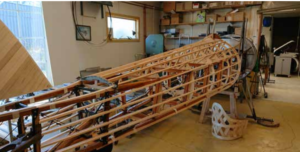
Kroppens primära struktur och samtliga beslag var i gott skick.
