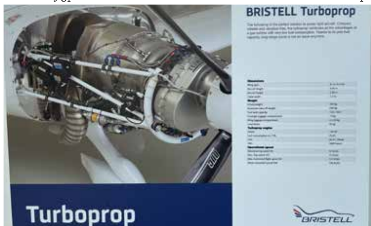
Här ett flygplan med den franska turbinmotorn från Turbotech på 140hk, mycket spännande!
