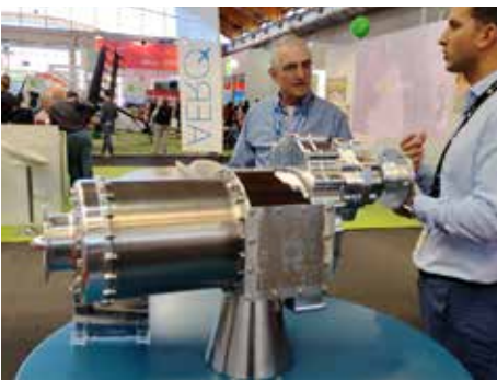
En grekisk turbinmotor på 130hk fortfarande under tidigt utprovningsstadium.
