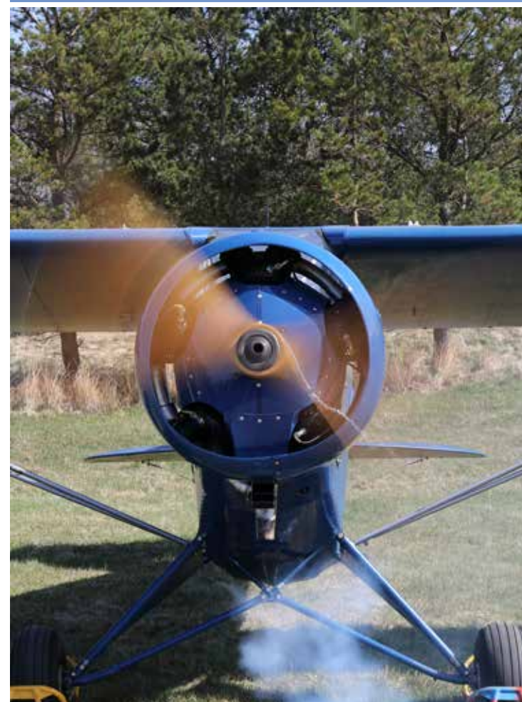
Le Blond stjärnmotor, 90 hk, varmkörs.
