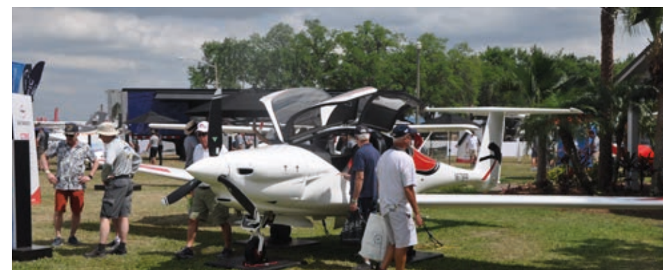
Pipistrel Panthera, 190 kt cruise, finns f.n. att köpa som experimental, planerad certifiering för normalklass nästa år
