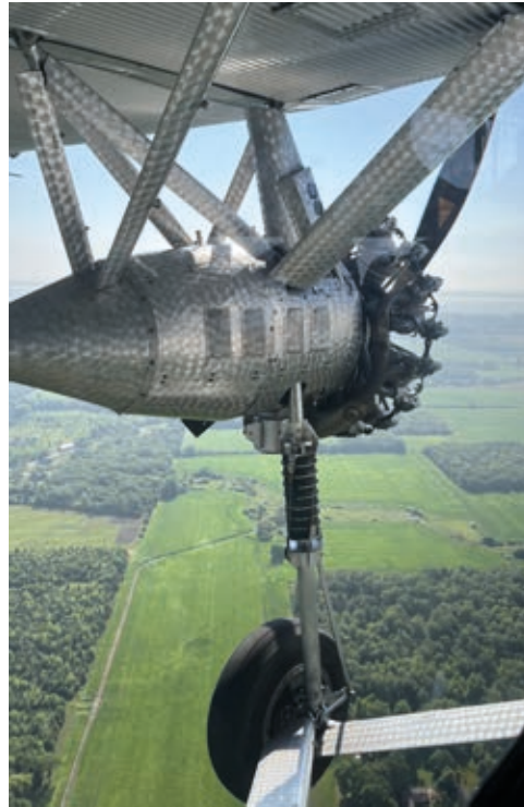
Flygning i Ford Trimotor. Notera motor instrumenten på motorn. Enda sättet piloten vet status på motorn.
