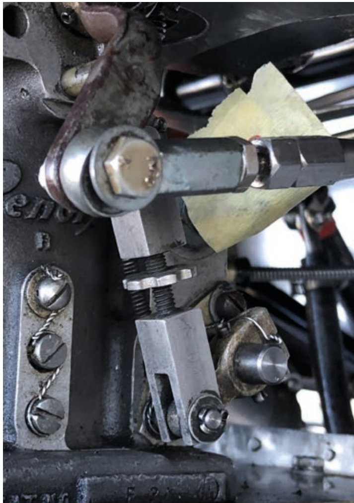
Bilden visar mitt gamla servo med tumhjulet och fjäder som är i vald "blandnings-urfasning"
