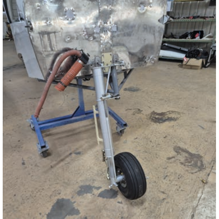
Smart lösning för att slippa veka noshjulsgafflar
